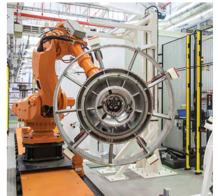
fot.: Kadłub pośredni do silnika PW800, który napędza m.in. business jety, w trakcie obróbki na zautomatyzowanej linii robotów ABB.
